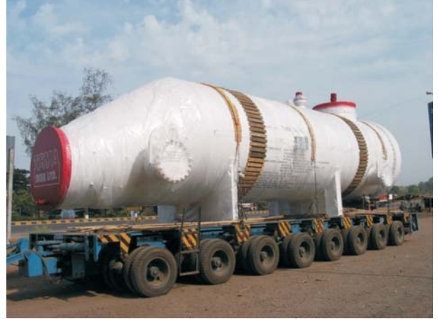
Service : Process Gas Reheater Type : NEN M.O.C. : SA516 Gr70 Wt. : 105 MT
