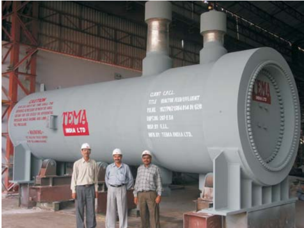
Service : Reactor Feed Effluent Type : DFU (Screw-Plug/Breech-Lock) M.O.C. : SA336 F22 CL3+SS347 Clad Wt. : 130 MT
