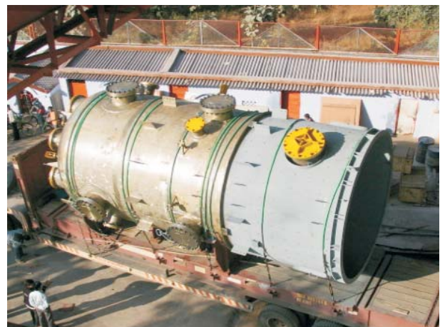
Service : HTF Condenser Type : NEN (V) M.O.C. : SS316 L Wt. : 35 MT Tube Qty. : 7700
