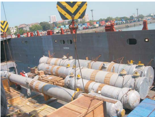
Service : Butadiene Extraction Plant Type : AES, AEU, CES & AEM M.O.C. : SA516 GR60+SA316L Clad Wt. : 233MT
