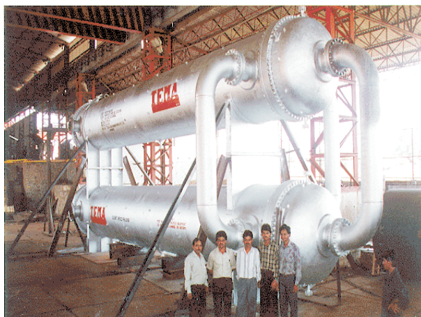
Service : Gas-Gas Exchanger Type : BEM M.O.C. : SA387 GR11 Cl2 Wt. : 150 MT
